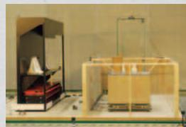
地震動を再現する装置を使って地震発生時に免震装置がどのように作動するのかを検証しています
