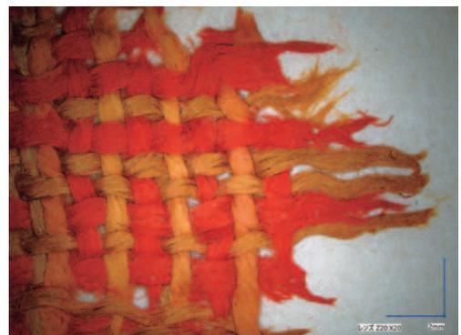
顕微鏡画像 (×20) 縦縞、横縞切替え部分 (経糸方向↔)
