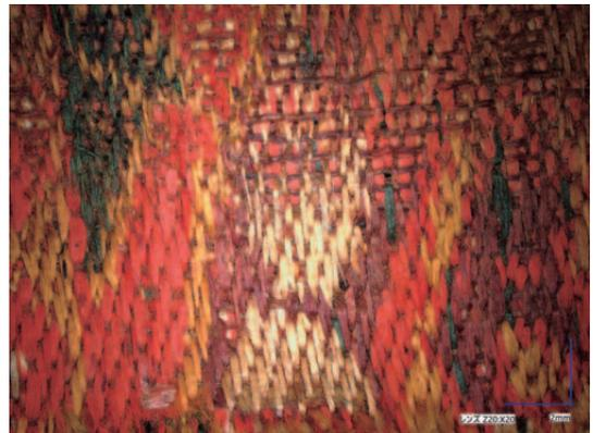
顕微鏡画像(×20) 経糸交替、緯糸露出部
