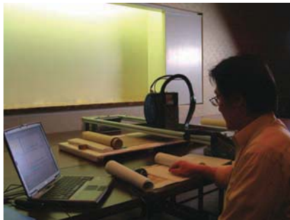
ポータブル蛍光X線分析装置による絵巻の彩色材料調査 Analysis of painting materials using a portable X-ray fluorescence spectrometer
